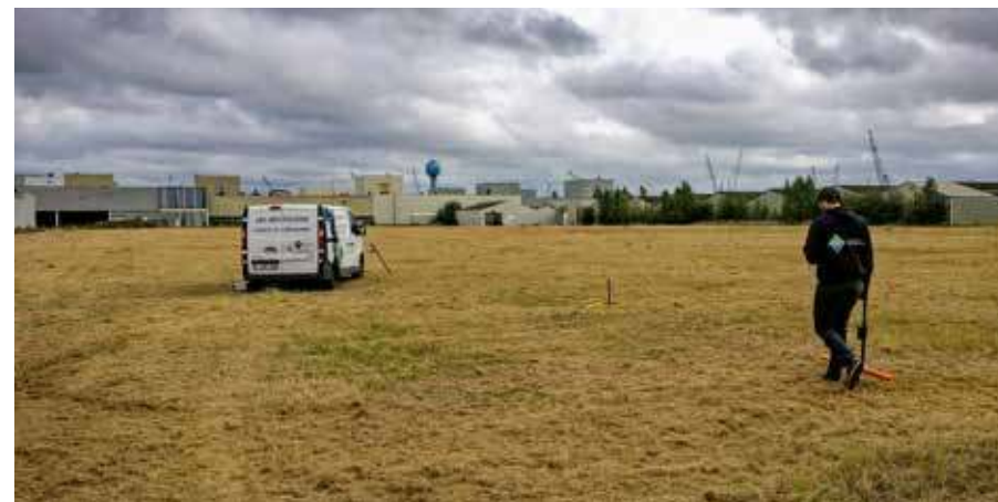
Uitvoeren van een EMI scan op de site van General Motors in Antwerpen.
