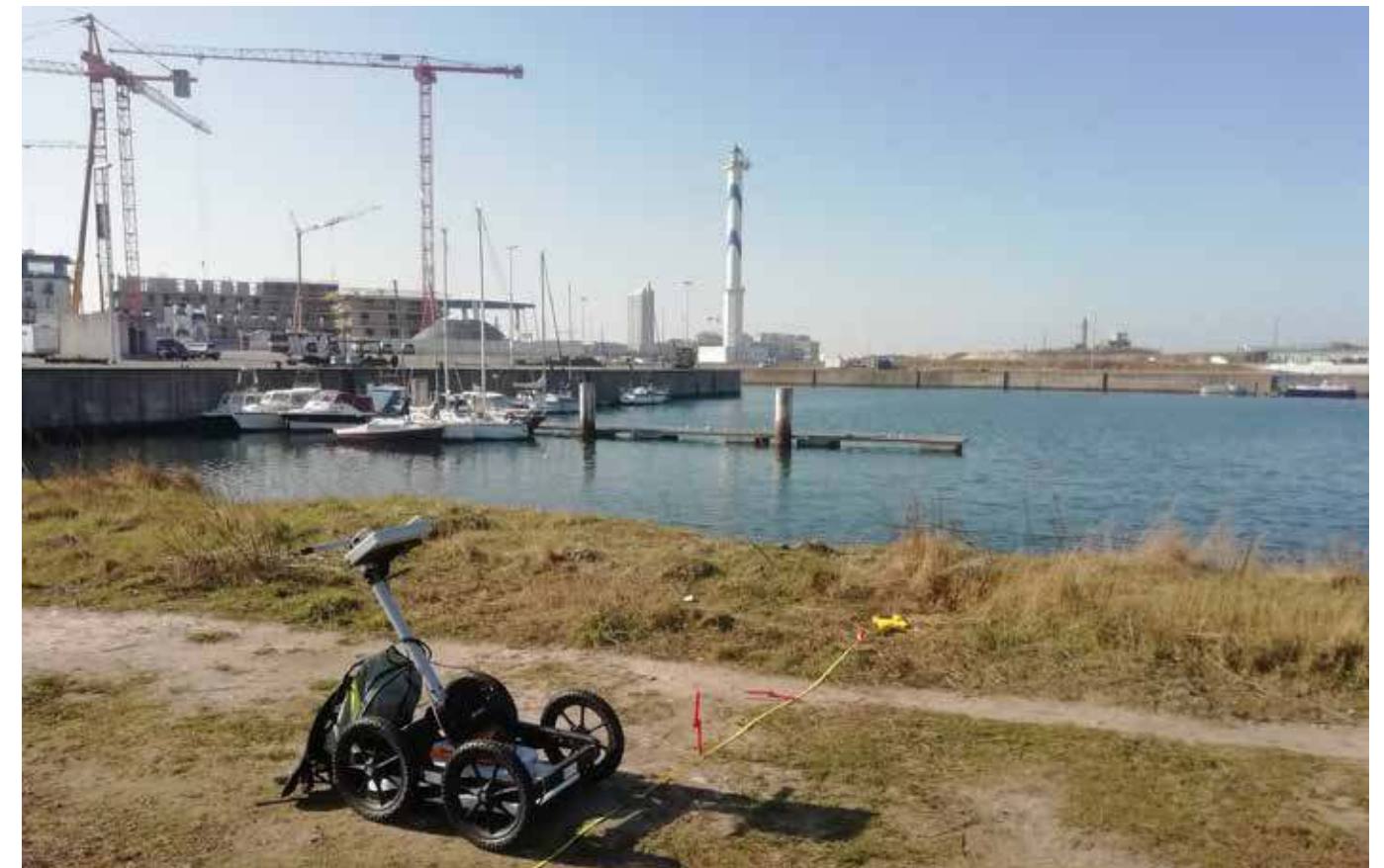
Met de GPR op zoek naar resten van bunkers in Oostende.
